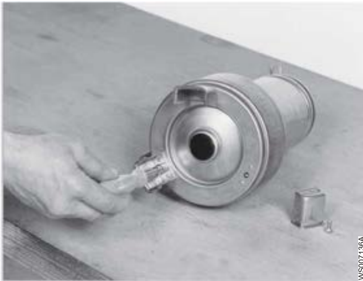
Abbildung 32: Entfernen des Pumpenfußes
